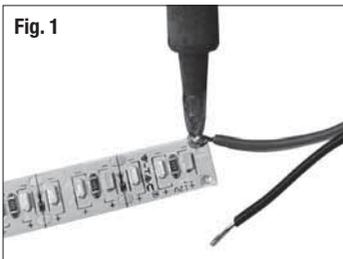
In caso sia necessario saldare dei nuovi cavi utilizzarli prestagnati e delle sezioni opportune; filo di stagno senza piombo con flussante no clean. La saldatura deve essere eseguita con saldatore a 350°C per un tempo massimo di contatto di 2 sec per evitare la delaminazione della piazzola di saldatura. Per la saldatura fare riferimento alla Fig. 1.
